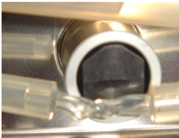
Рис. 3 Деформации трубки дозирующего клапана из-за неправильной установки головки
