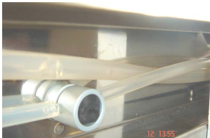
Рис. 2 Правильное (А) и неправильное, при ошибке установки головки (Б), положения трубок.
