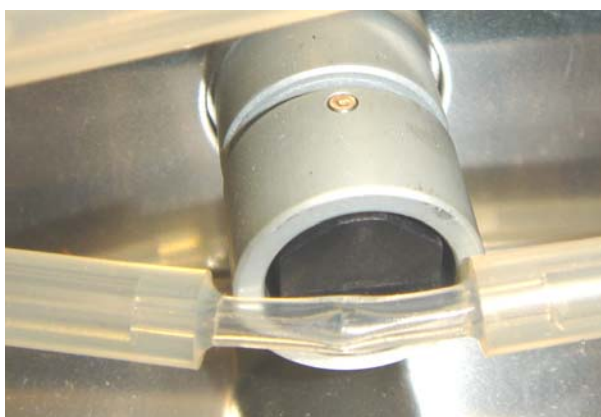
Рис. 5 Деформация трубки в результате длительного простоя прибора
